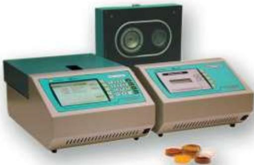
Messkapazität erweiterbar: Bis zu neun Zusatzmesskammern LabPartner-aw (rechts) können an einen LabMaster-aw angeschlossen werden.
